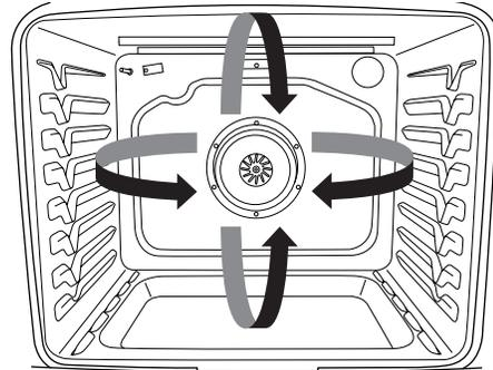
Durant la cuisson ou le rôtissage par convection, les éléments de cuisson au four, cuisson au gril et de convection s'allument et s'éteignent par intermittence tandis que le ventilateur fait circuler l'air chaud. Durant la cuisson au gril par convection, les éléments de cuisson au gril et de convection s'allument et s'éteignent par intermittence.
